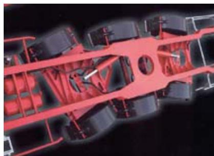
Le S3.17 et S3.20 sont équipés par défaut d'un système Renders X-steering et d'un essieu élévateur
