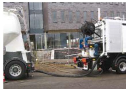
Système de remplissage pneumatique pour recharger des liants
