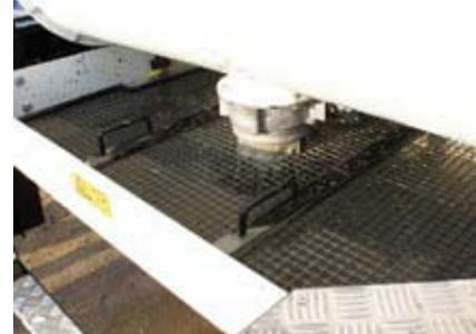
Dans le mélangeur de stock, une pompe rotative est placée, laquelle se charge du pompage du mortier sur le chantier.
