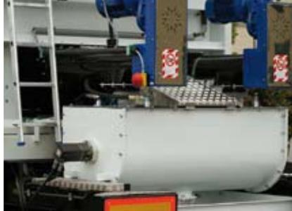
Avant que le mortier coulé ne soit pompé, il est mélangé dans le mélangeur rapide
