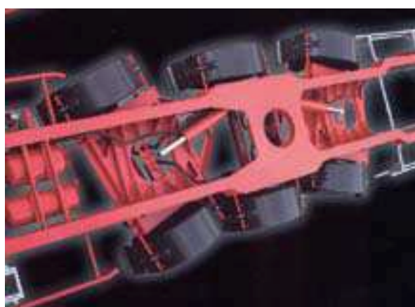
La F3.20 est équipée de façon standard d'un système Renders X-steering et d'un essieu élévateur.
