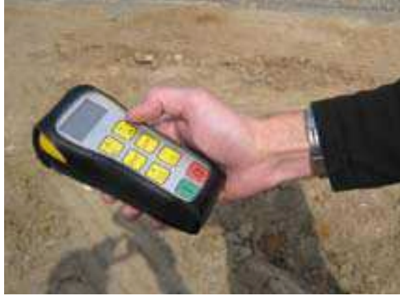
Avec la commande à distance, la machine peut être commandée depuis le chantier
