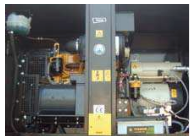
Le moteur diesel puissant à 4 cylindres avec générateur et compresseur volumétrique rotatif garantit un haut niveau de productivité
