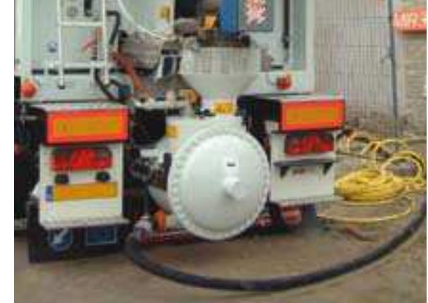
Dans le vase mélangeur, les matières premières sont uniformément mélangées puis pompées via le tuyau de transport.
