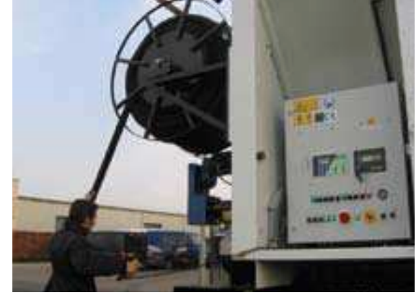
Le tuyau de transport peut rapidement et simplement être enroulé à l'aide de l'enrouleur électrique
