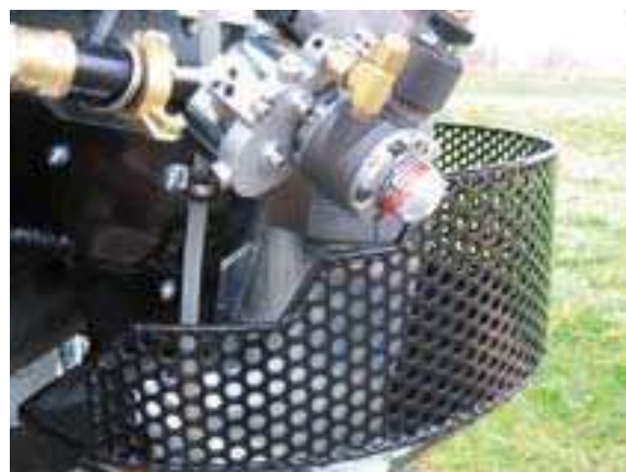
Les fibres peuvent être dosées automatiquement et être mélangées au mortier de sol
